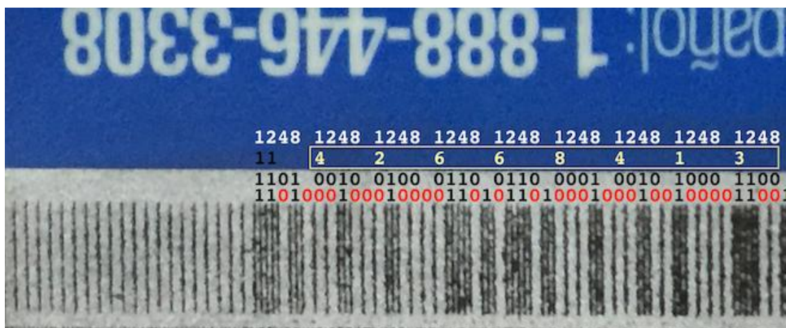
Ilustración 6: Pistas de una tarjeta de banda magnética con dos pistas Nota. Reproducido de Magspoof (2015).
