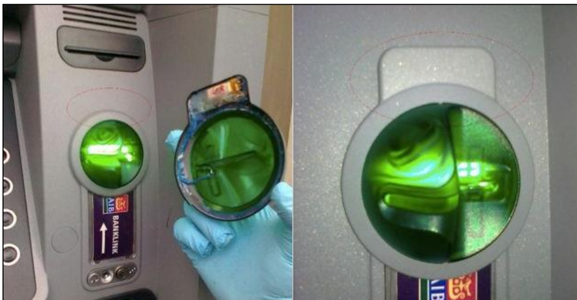
Ilustración 9: Skimmer en un cajero automático
