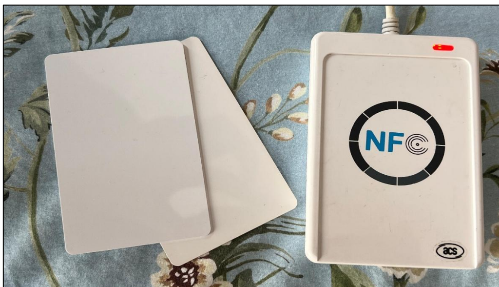
Ilustración 17: Lector ACR122U y tarjetas mágicas Nota. Elaboración propia.
