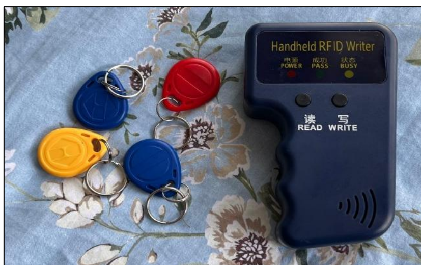
Ilustración 14: Lector RFID y etiquetas regrabables
